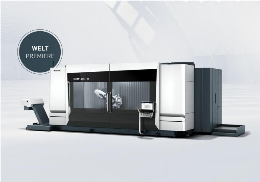
*Die DMF 400|11 verfügt im Vergleich zum Vorgängermodell über einen vergrößerten Arbeitsraum mit Verfahrwegen von 4.000 x 1.100 x 1.050 mm.*
